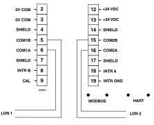
Figure 22-LS2000 LON Wires
